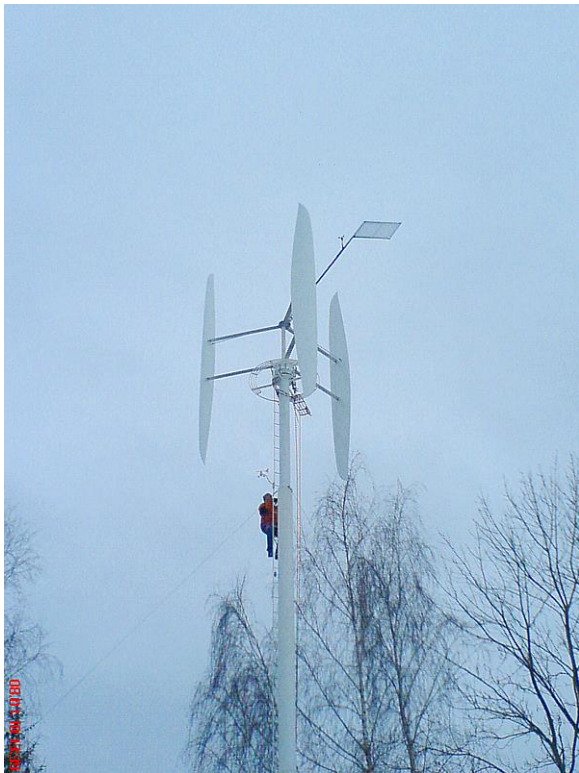
Bild 7 Zum Antrieb des Exzenters dient eine kleine Hilfs-Windfahne
